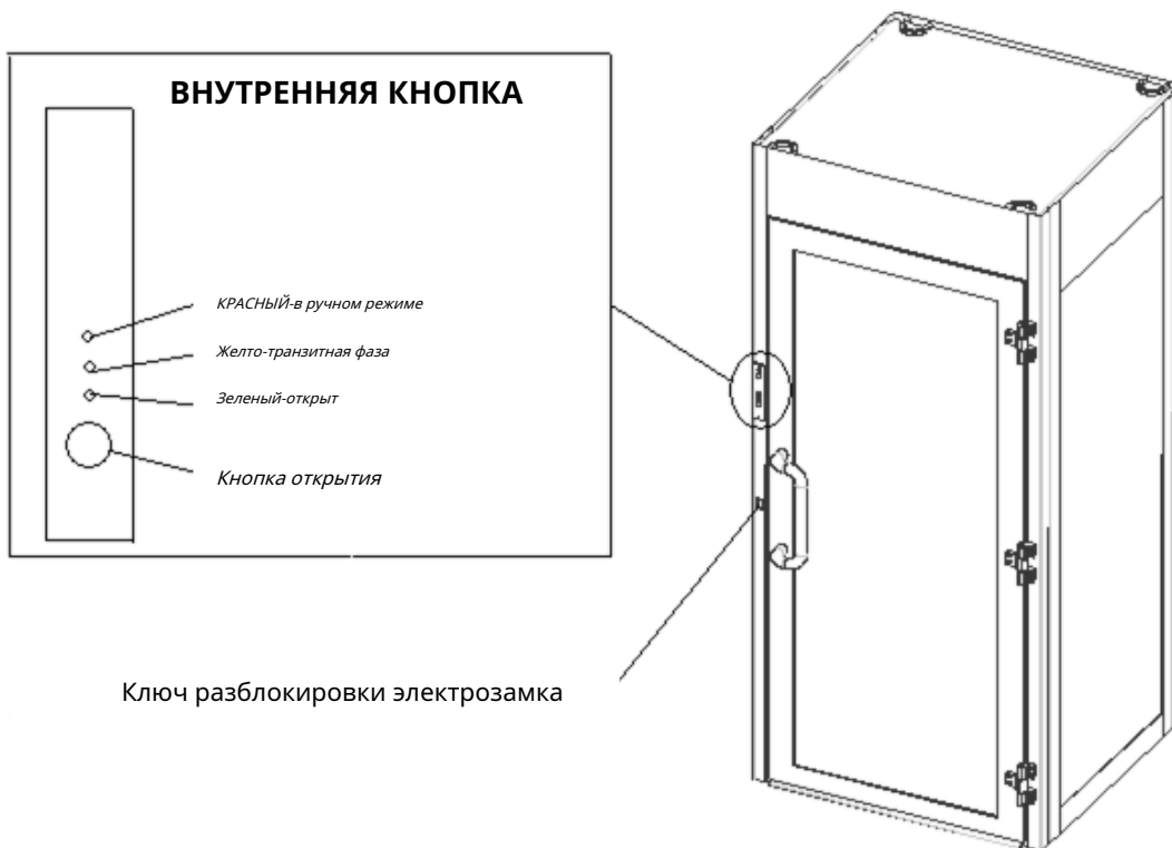
Рисунок 2-2 ВИД ВНУТРЕННЕЙ СТОРОНЫ
