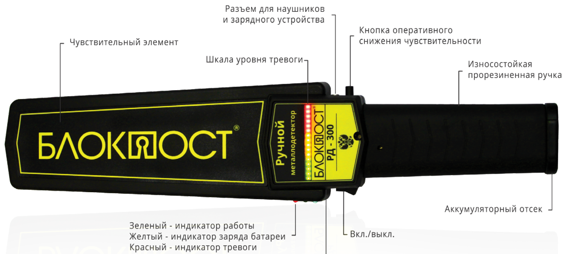
Устройство металлодетектора
